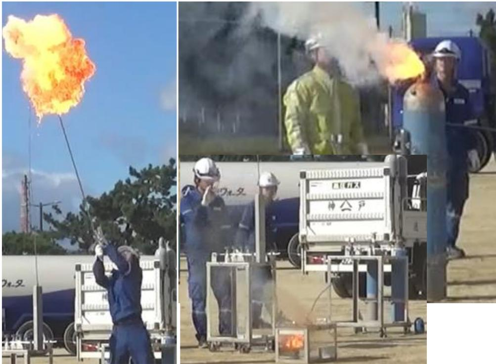
実験第3部 可燃性ガス（LPガス、水素ガス）燃焼比較実験
