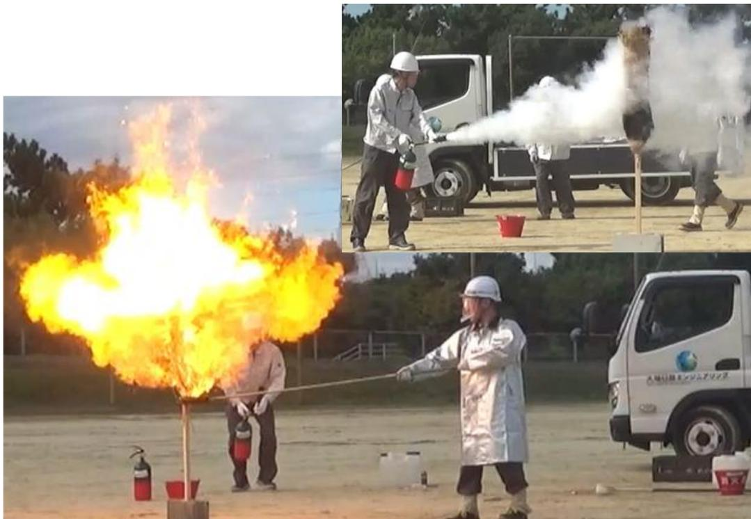
実験第2部 特殊材料ガス（モノシラン）の燃焼実験
