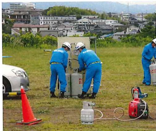
実験第1部 支燃性ガス（液化酸素）による燃焼実験
